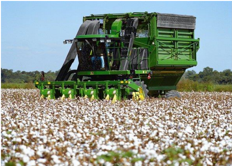
Şəkil.1. John Deere 9970 pambıqyığan kombaynın ümumi görünüşü
